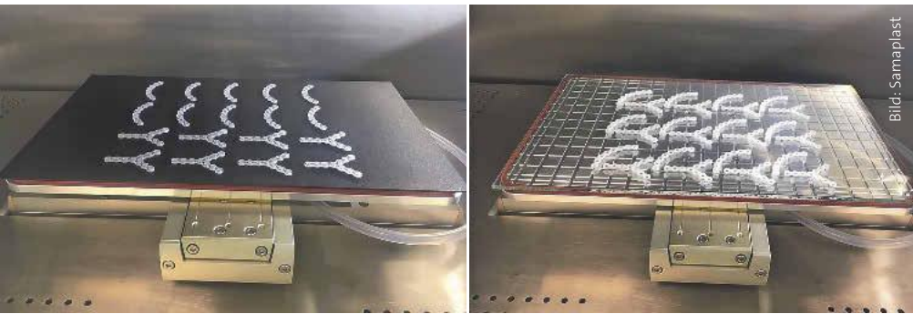
Implantate aus Resomer für die Gesichtschirurgie – auf unterschiedlichen Bauplatten gedruckt
