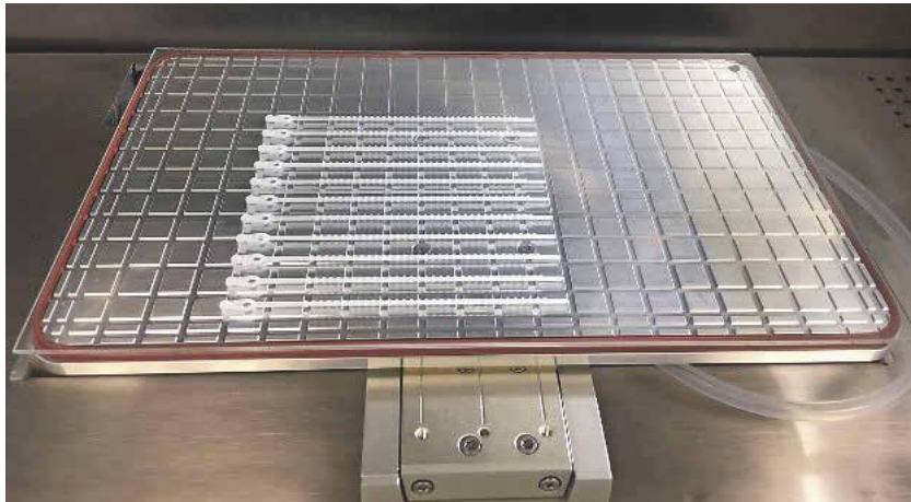
Implantat-Kabelbinder aus Resomer im Bauraum des 3D-Druckers Freeformer
